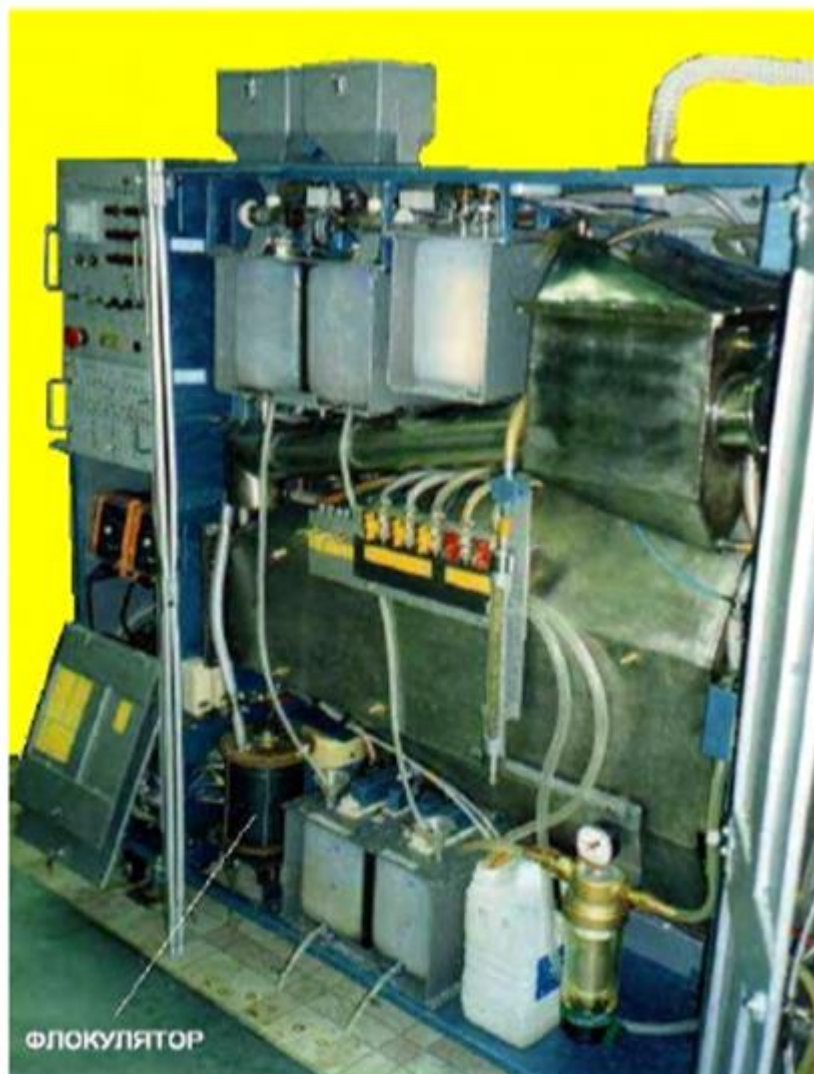
Рисунок 1.4 - Установка для флокулярно-микрофлотационной сепарации отработанных смазочно-охлаждающих водомасляных эмульсий
