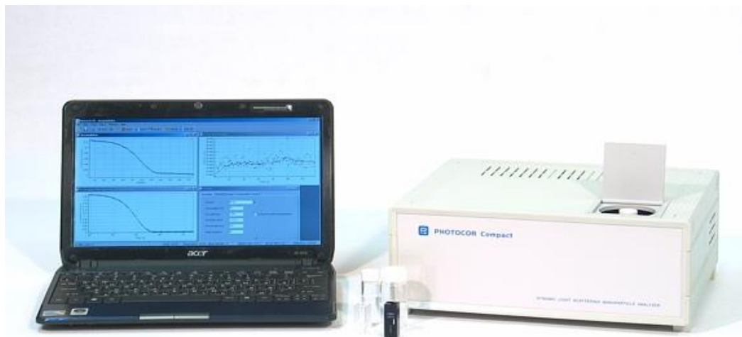
Рисунок 3.3 – Процесс измерения размеров частиц на анализаторе «Photocor Compact»
